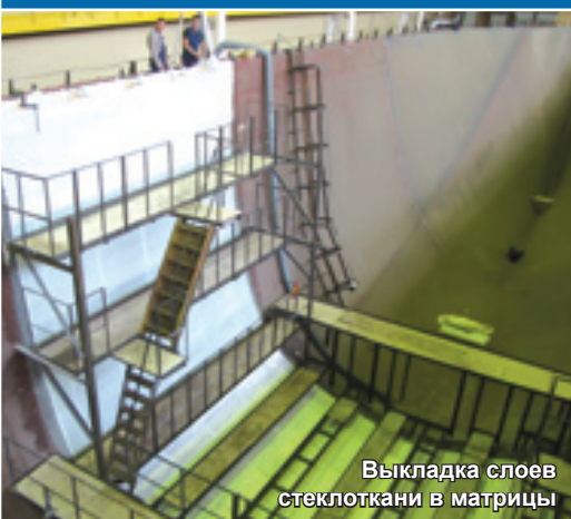
Сформированный методом вакуумной инфузии корпус корабля ПМО
