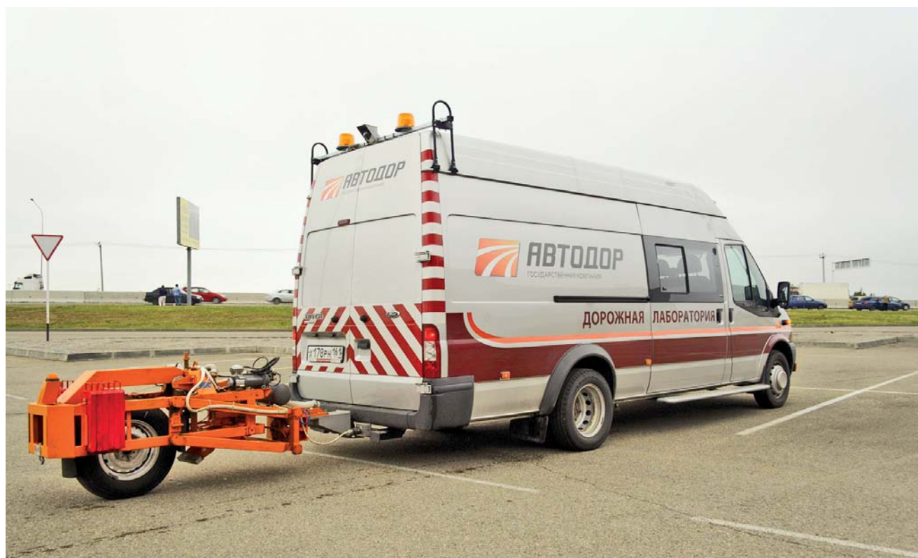
ООО «Автодор-Инжиниринг» совместно с саратовским научно-производственным центром «Росдортех» реализовали инновационный проект комплексной модернизации передвижной дорожной лаборатории и одноколенного прицепа ПКРС – 2 РДТ для конструктивного обеспечения выполнения измерений коэффициента сцепления по ГОСТ 33078-2014
