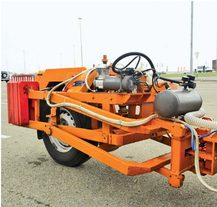
Одноколенный прицеп ПКРС – 2 РДТ для конструктивного обеспечения выполнения измерений коэффициента сцепления по ГОСТ 33078-2014
