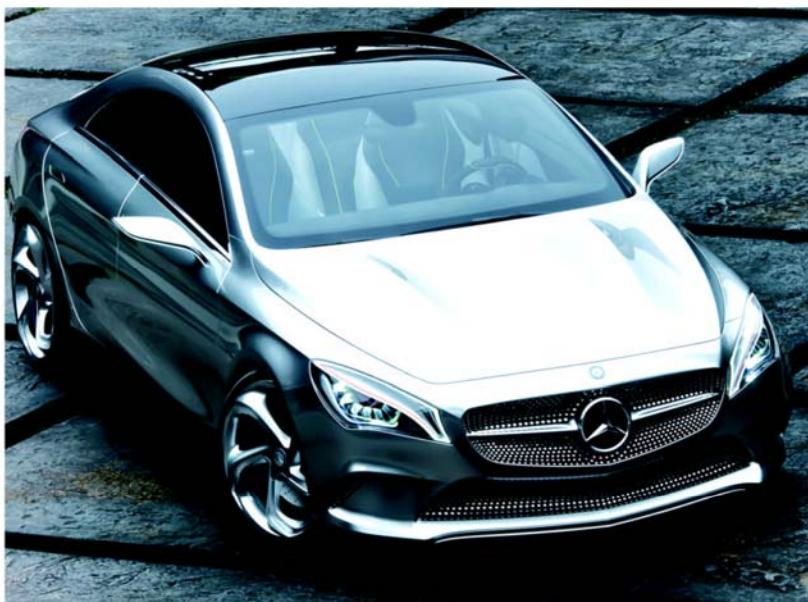
Mercedes-Benz Concept Style Coupe — автомобиль ближайшего будущего, его длина составляет 4,64 метра, а ширина около 1,9 метра, и высота 1,4 метра. Внутри машины, под капотом — двухлитровый двигатель, работающий на бензине. Кстати, двигатель с турбонадувом, а это значит, что Mercedes-Benz CSC получился очень скоростным автомобилем. Мощность двигателя 211 лошадиных сил. Трансмиссия Mercedes-Benz Concept Style Coupe оснащена новой роботизированной семиступенчатой системой полного привода.
