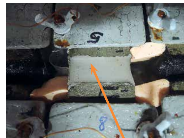
Рис. 5 Образец с тиоколовым герметиком. Нижняя точка температуры 15-го цикла
